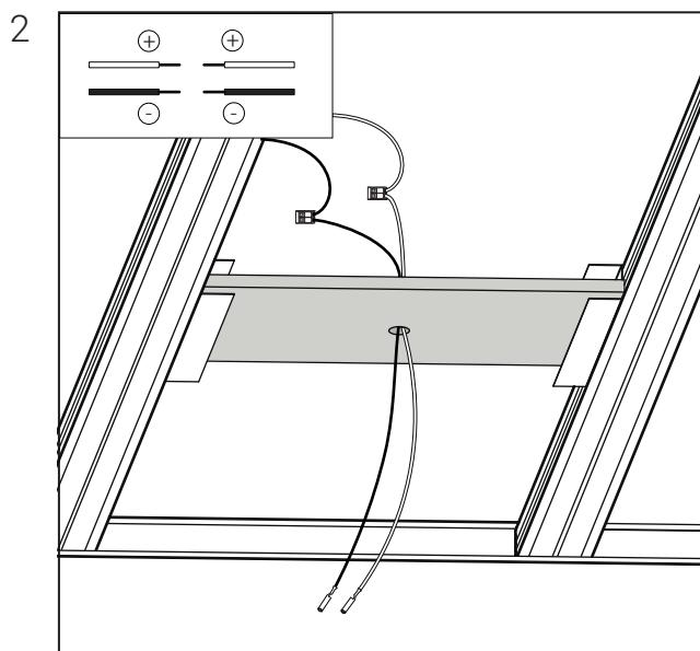
Проденьте провода для подключения (поз. 6 ) в отверстия и подключите клеммы к кабелю питания.
