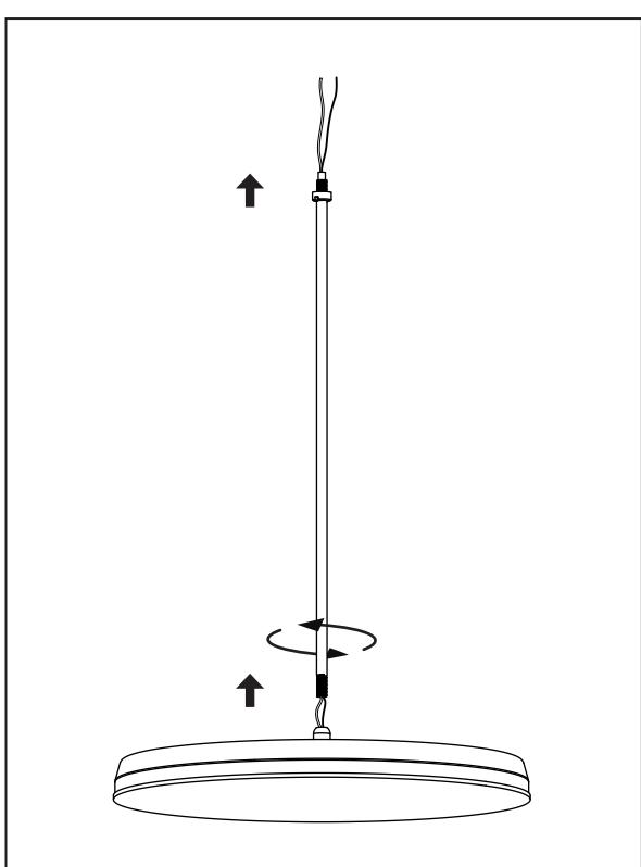
Проденьте кабель светового модуля светильника EVO NO (поз. 2) через штангу (поз.5) так, чтобы стопорная гайка оказалась сверху. Закрепите штангу на светильнике с помощью резьбового соединения.
