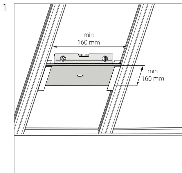
Установите закладную на несущие металлоконструкции по уровню, горизонтально.
