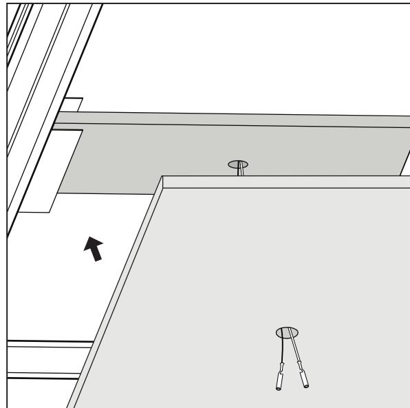
Установите листы гипсокартона, сделав отверстие диаметром 12мм в точке крепления светильника.
