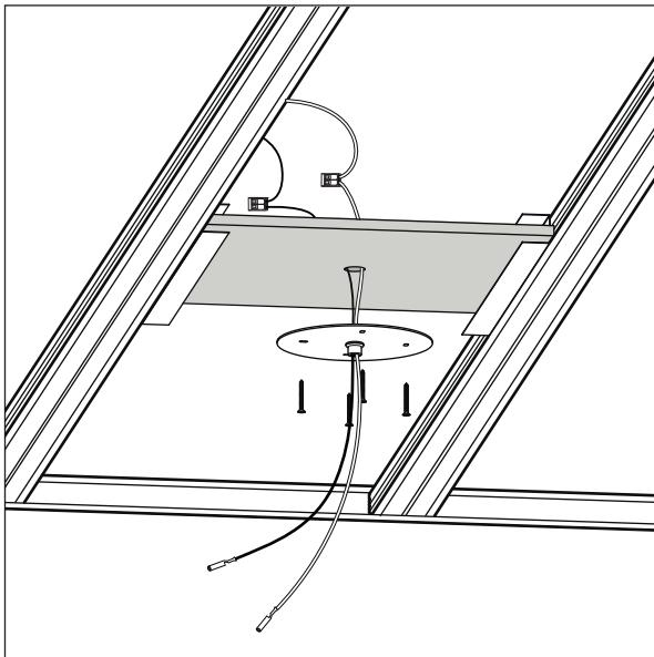
Установите потолочное крепление (поз. 3) на закладную деталь.
